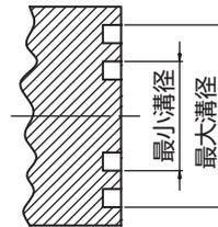
第一回目の溝入れ加工が終了したら、その溝幅を有効加工径の範囲内での拡大は可能です。
