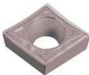
アルミ、アルミ合金、非鉄金属の仕上げ切削用、及び、ステンレス鋼材の仕上げ切削に適用いたします。シャープな刃先と、独自のブレード形状により低抵抗切削及び良好な切りくず処理を実現いたします。
