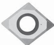
アルミ、アルミ合金その他の非鉄金属加工用ブレードです。また、モリブデン、焼結合金鋼材、ステンレス鋼材の仕上げ加工にも適します。シャープな刃先と独特なブレード形状により、切削抵抗が非常に小さいので不安定で肉厚の薄いワークの加工にも適します。
