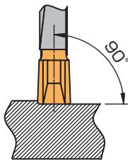
突切り用工具は加工物のセンタに対して $\pm 0.05\text{mm}$ の高さにセットしてください。
